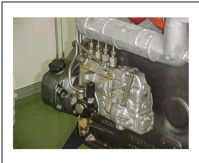
Vista general de la bomba en línea montada.
